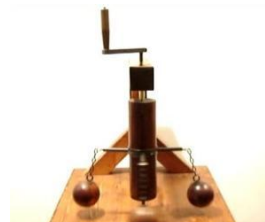
Volant d'inertie de Léonard De Vinci
